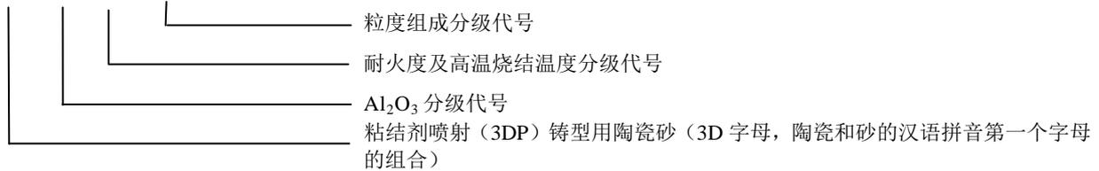
示例：3DTS-V-1-100/200 表示 Al<sub>2</sub>O<sub>3</sub> 含量（质量分数）> 50%，耐火度 ≥ 1800℃，高温烧结温度 ≥ 1600℃，粒度组成代号为 100/200 的陶瓷砂。
