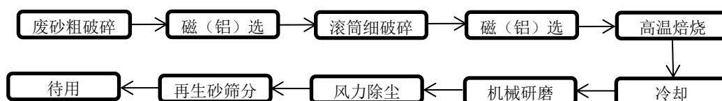
图 4 热法+机械法再生流程图
