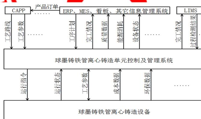
图 A.1 离心铸管单元数据流图
