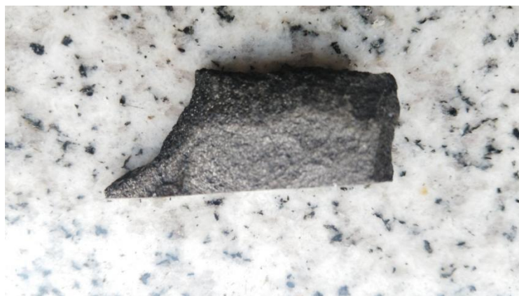
图 17 机体 HT250 底平面 热裂缺陷形貌
