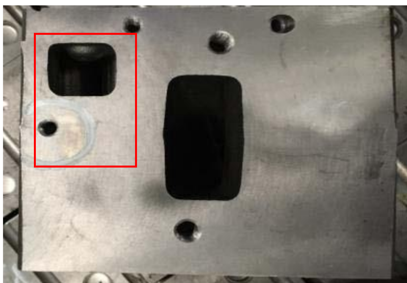
国 IV 气缸盖侧壁漏水
